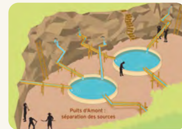
— Le captage et la séparation des eaux douces et salées dans le puits d'Amont avant qu'il ne soit recouvert d'une galerie voûtée pour protéger les sources
